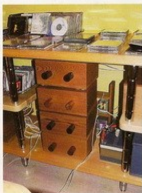
Les amplificateurs Rock Solid ce sont les précédents des actuels MIPA (Mains Independent Power Amplifier), des modèles transistorisés à circuits symétriques alimentés sur batteries. La puissance nominale de chaque bloc mono est d'une trentaine de watts.
