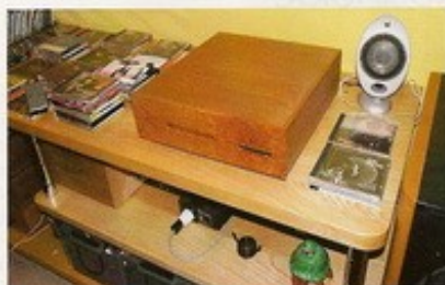
Le lecteur DVD/CD Pioneer DVD 350 Il est réhabilité d'une belle parure en essences de bois rares, largement modifié et alimenté sur batteries.
